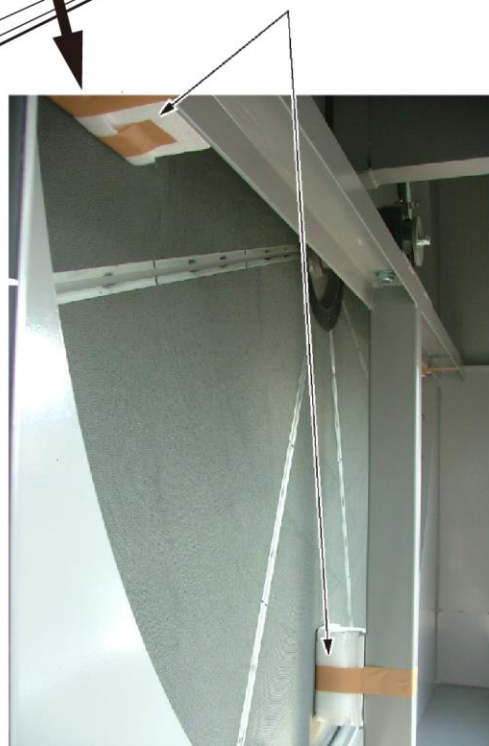
用于固定转轮端面的泡沫聚苯乙烯 (转轮直径小于 2650mm)
